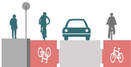
Figur 6. 2-1-väg, där röd beläggning används på cykelfilerna. (Pyöräliikenteen suunnittelu, s.69)
