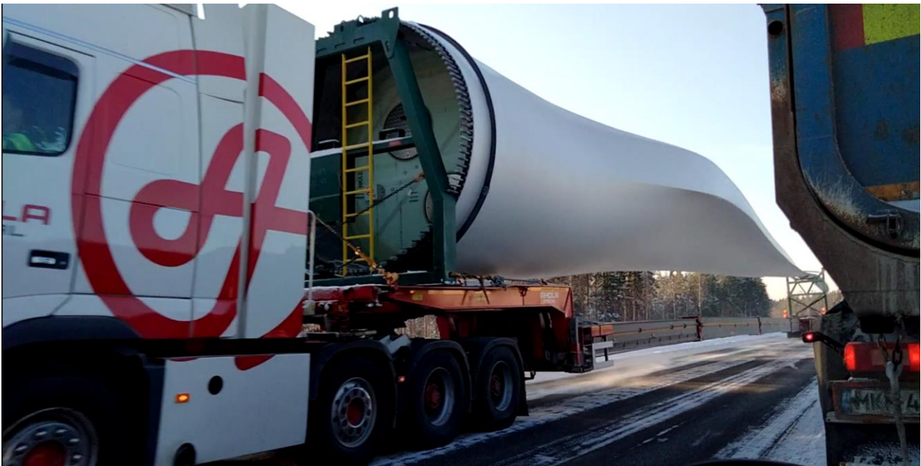
Kuva 10: Tuulivoimalan roottorin lapa maantiekuljetuksessa 22.2.2023 ©T. Järvinen
